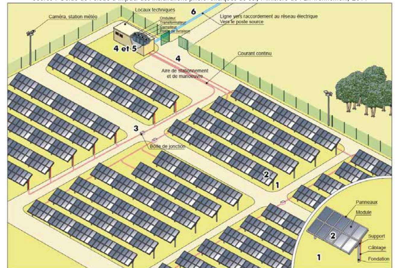
Illustration 8 : Schéma de principe du fonctionnement d'un parc photovoltaïque
